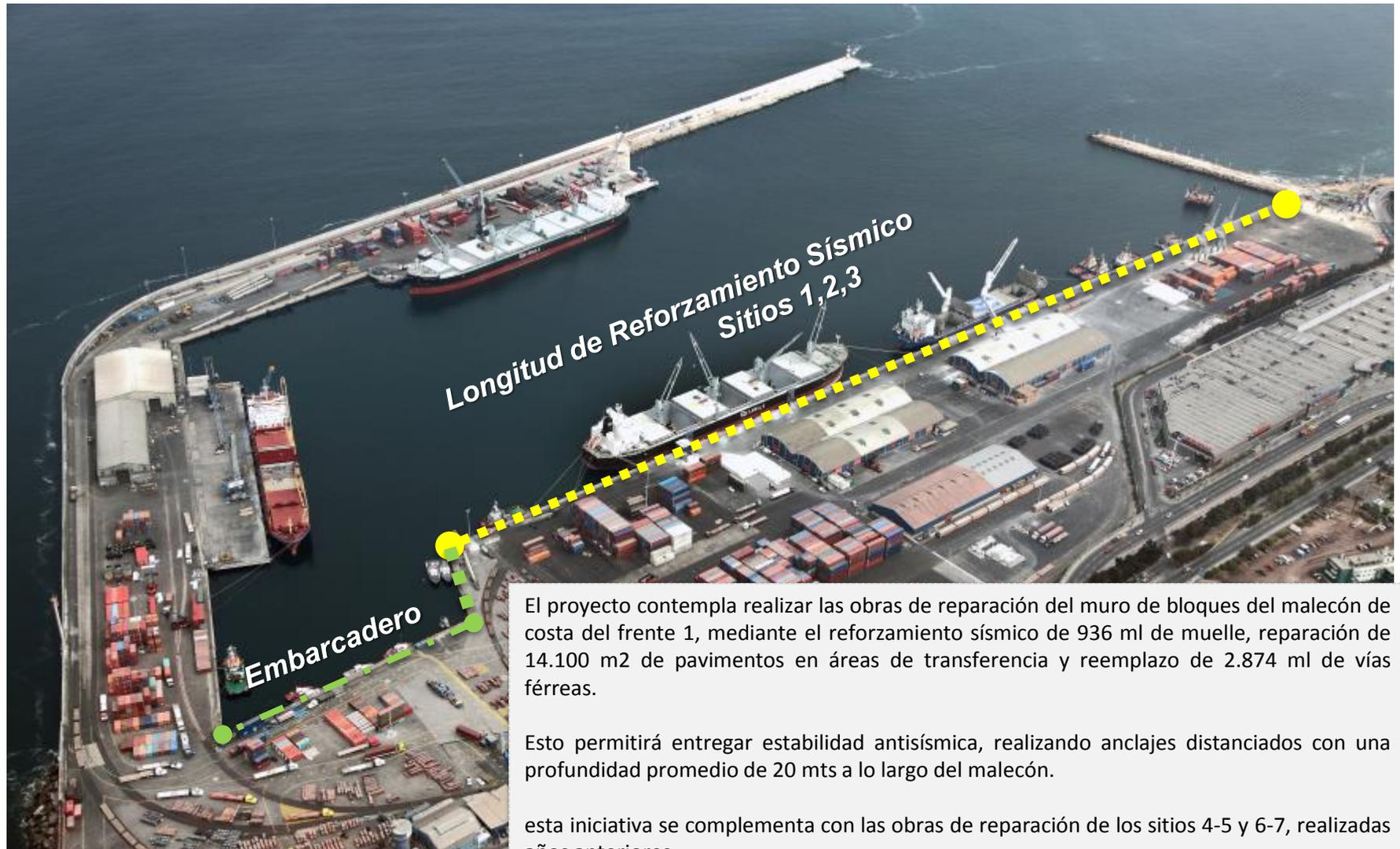
El proyecto contempla realizar las obras de reparación del muro de bloques del malecón de costa del frente 1, mediante el reforzamiento sísmico de 936 ml de muelle, reparación de 14.100 m<sup>2</sup> de pavimentos en áreas de transferencia y reemplazo de 2.874 ml de vías férreas.
