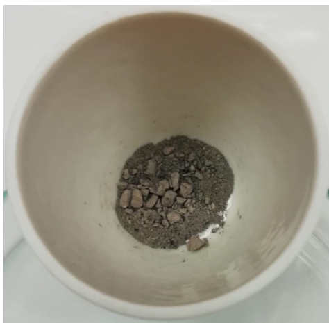
Figura 8. Aspecto de una muestra convertida en ceniza después de su calcinación en crisol a 600^\circ\text{C} en mufla con atmósfera ambiental.
