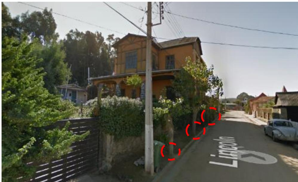
Solicitan orientaciones cómo proceder en la excavación del sector de vereda frente al inmueble, puesto que el muro de fundación existente no se encuentra al nivel de la vereda y se deberá excavar para llegar nivel.
