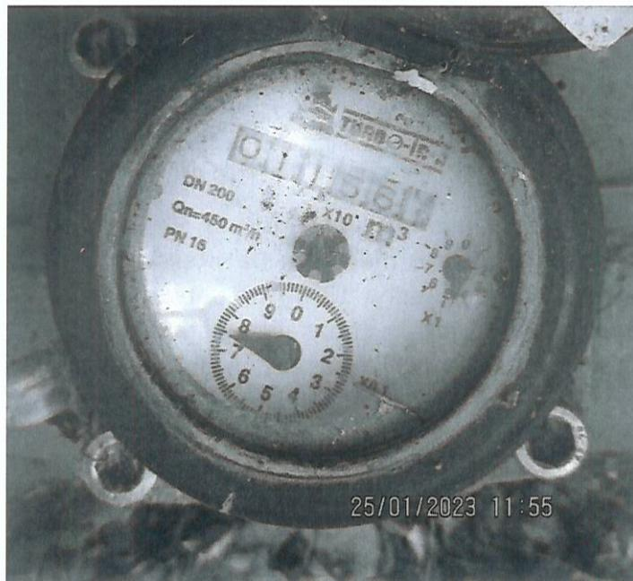
**Fotografía N°6:** Vista del totalizador del caudalímetro instalado en la tubería asociada al sistema de captación de aguas no autorizado, en la ribera izquierda del Estero Derecho.
