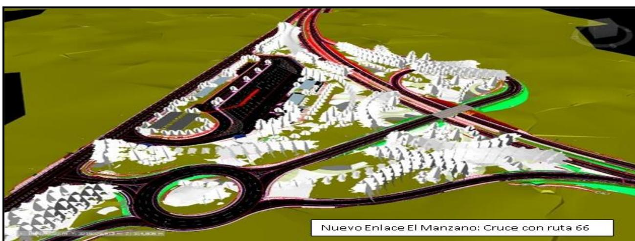
Imagen: Se observa cruce desnivelado, cuyo diseño permite la conexión entre ambas rutas (ruta 66 proyectada con la existente) en todas las variantes, incluidos los retornos hacia el oriente o poniente.
