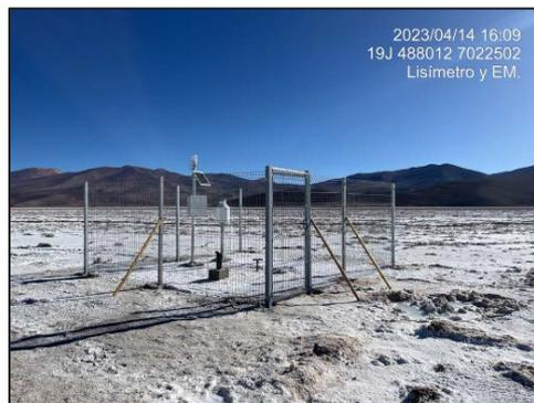
Lisímetro y estación meteorológica
