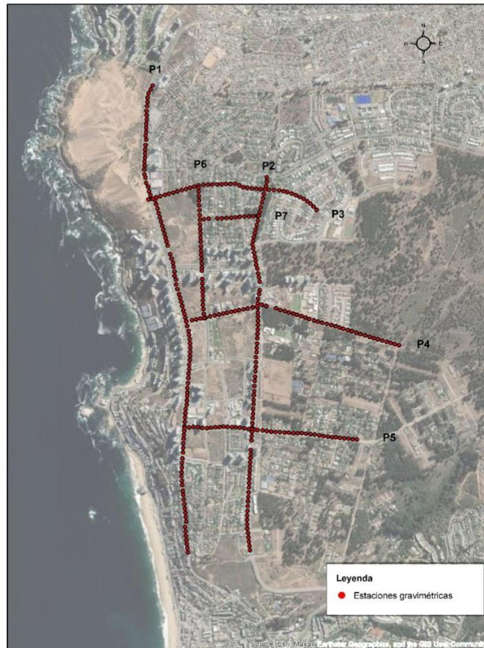
FIG. 15. Área de levantamiento de perfiles gravimétricos. Imagen: Esri, Maxer, Earthstar geographics, and the GIS User Community.
