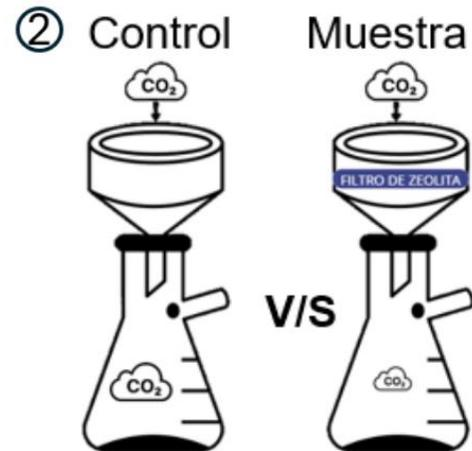
**Figura 2.** Montaje del sistema de validación de eficiencia del filtro de Zeolita
