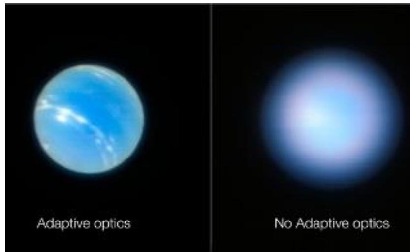
Imagen de planeta con óptica adaptativa (izquierda) y sin óptica adaptativa (derecha)
