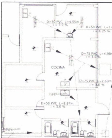
Figura N° 16 – Planimetría Original del Sistema de Desagüe en Cocina del Liceo.
