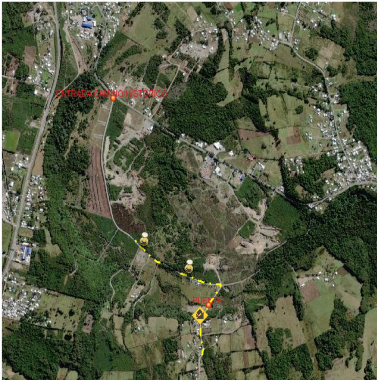
Imagen satelital de una parte del camino histórico. El camino punteado en amarillo presenta baches durante todo el trayecto. En las áreas resaltadas con dos puntos se generan las mayores problemáticas por estancamiento de aguas lluvias en medio del camino.
