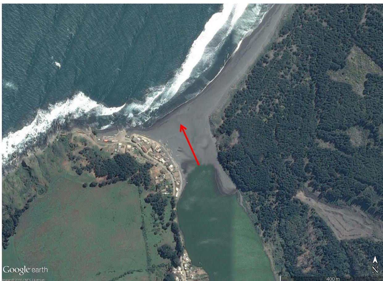
Figura 2. Zona de apertura y dirección de excavación del canal.
